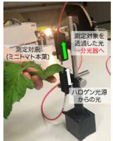
農作物が吸収した肥料の量を推定するための分光分析装置
